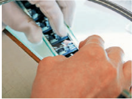
■用特殊膠紙修補斷裂的菲林齒孔。
