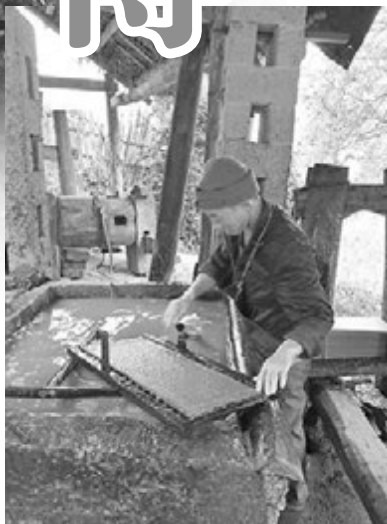
■加滑水是最考驗技術的步驟，加好滑水之後便要用竹簾在漿池內“抄紙”。圖為張明星在作坊裡造紙。
