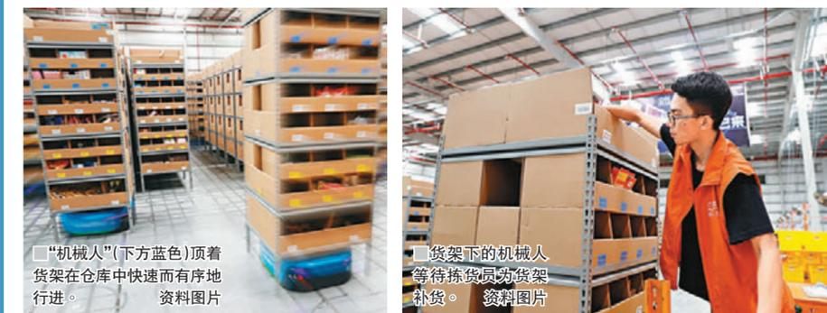
■“机械人”（下方蓝色）顶着货架在仓库中快速而有序地行进。
