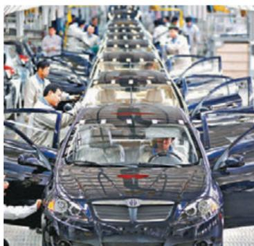
圖為智能化率達到75%以上的華晨汽車智能製造試點車間的中華汽車生產線。
