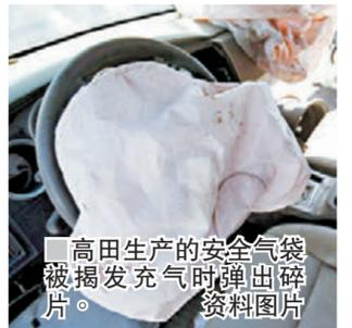
高田生产的安全气囊被揭发充气时弹出碎片。资料图片
