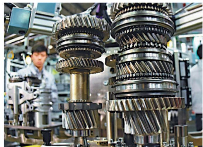
▲武汉正全力打造支撑长江经济带发展之国家先进制造业中心。工人于东风特拉克汽车变速箱公司生产线工作 网络图片
