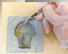
5. 將泡沫合成乳膠倒入模具後，放入焗爐烤焗，用來做人偶的身體內部。
