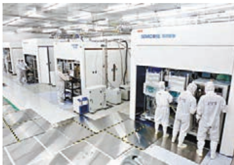
●中電科實現離子注入機全譜系產品國產化。圖為該公司科技人員正測試離子注入機。中新社
