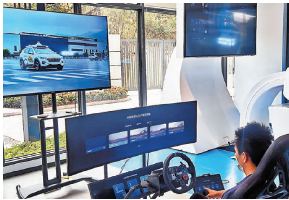
●廣州自動駕駛MaaS示範基地可通過百度5G雲代駕系統實時操控北京的網聯汽車。受訪者供圖
