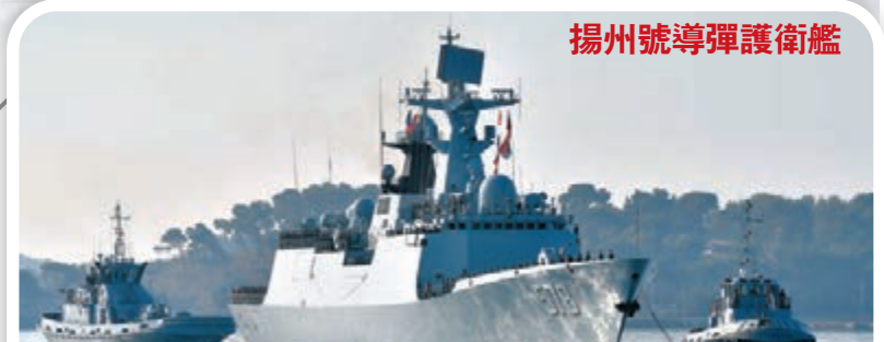
揚州號導彈護衛艦 艦長:135米 艦寬:16米 滿載排水量:4,000多噸 最大航速:27節 武器:YJ-83 反艦導彈、紅旗-16 防空導彈、魚-7 型魚雷、反潛火箭、直-9C 型反潛直升機等
