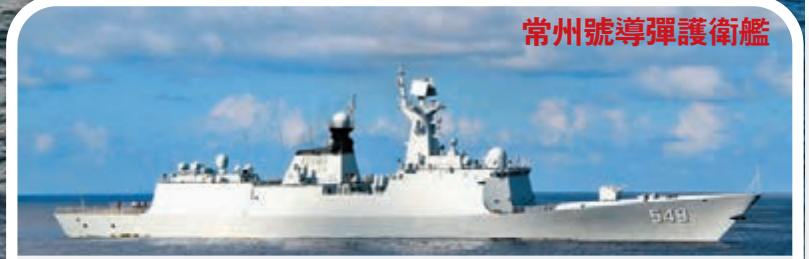
常州號導彈護衛艦 艦長:134米 艦寬:15.2米 滿載排水量:4,053噸 最大航速:27節 武器:YJ-83 反艦導彈、紅旗-16 防空導彈、魚-7 型魚雷、反潛火箭、直-9C 型反潛直升機等
