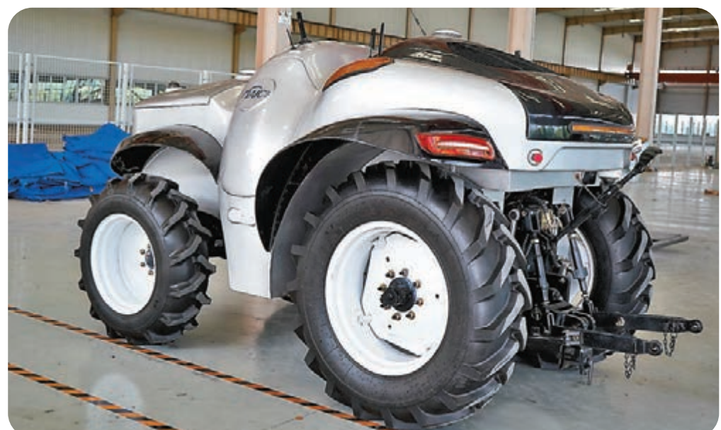
●位於洛陽市的國家農機裝備创新中心，香港文匯報記者見到了中國首台5G+氫燃料電動無人駕駛拖拉機。 香港文匯報記者劉蕊 攝
