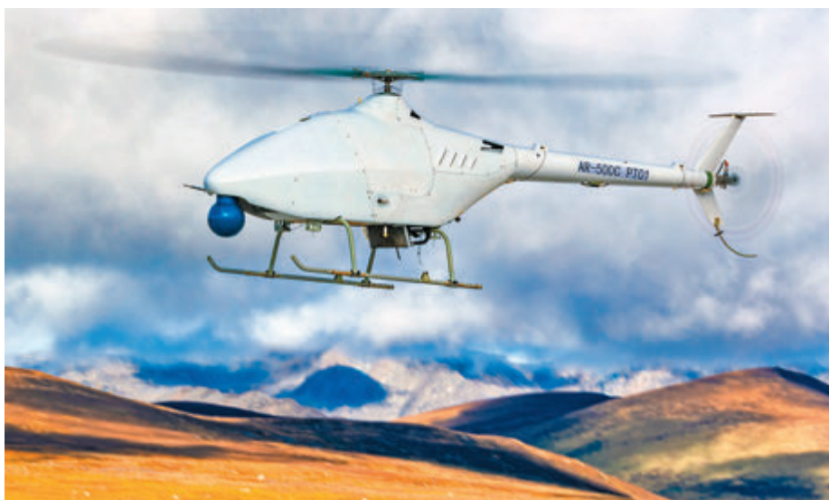
AR-500C以高原地區為主要應用場景,具備自動起降、自動懸停、超視距航線飛行、預編程飛行、航線在線重規劃和無線上傳等高級功能。
