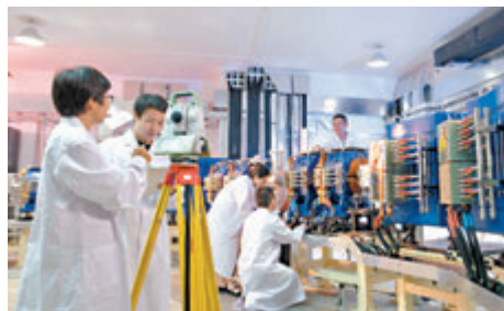
■ 國產質子治療系統實現重大突破。圖為科研人員對230MeV超導迴旋加速器進行安裝調試。 受訪者供圖
