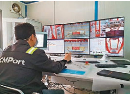
■ 通過5G應用，媽灣智慧港員工可以實現遠控岸橋吊機的操作業務。 香港文匯報記者李昌鴻 攝
