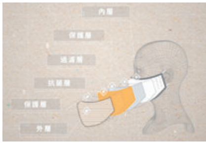
■「銅芯抗疫口罩」由六層功能物料構造而成。「銅芯抗疫口罩」官網圖片
