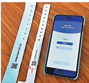
■監察手帶(藍色)及電子手環(白色)，均需配對居家防疫流動應用程式。網誌圖片
