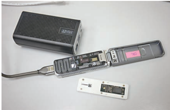
■近年推出小型單分子測序儀，體積僅如手掌般大。
