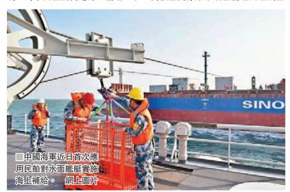
導組在福州輪甲板準備就緒,海軍 臨沂艦機動佔領福州輪左舷橫向乾 貨補給陣位,向福州輪發射撇纜, 索傳遞至臨沂艦,兩艦對接完畢。 福州輪隨即將乾貨集裝箱平穩地傳 送至臨沂艦甲板,模塊化航行橫向 補給系統補給裝置試驗順利完成。
