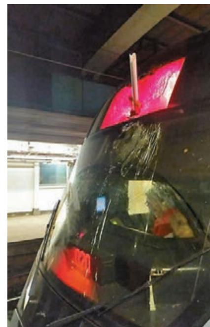
8 ■港鐵一列車的車頭擋風玻璃被管狀物貫穿。 網上圖片
