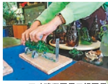
玻璃瓶要用刀鏢再用火燒，以冷縮熱脹原理把切割口斷開。
