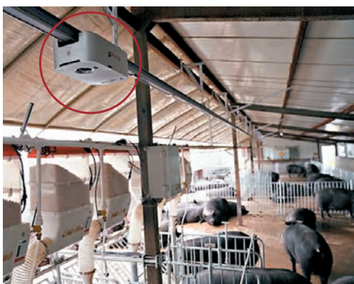
■鞋盒大小的養殖巡檢機器人(紅圈示)正在棚頂「巡邏」養豬場內的情況。網上圖片
