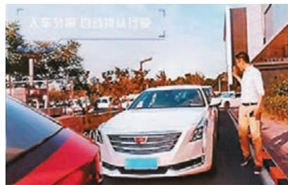
■自主泊車系統可通過簡單學習訓練，使車輛在司機下車後，在視距內沿固定路線泊車入位。
