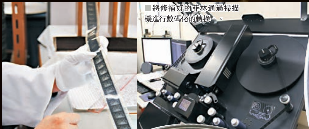
■診斷時會將老菲林一側固定，用手輕撫膠片尋找它的瑕疵與斑跡。
