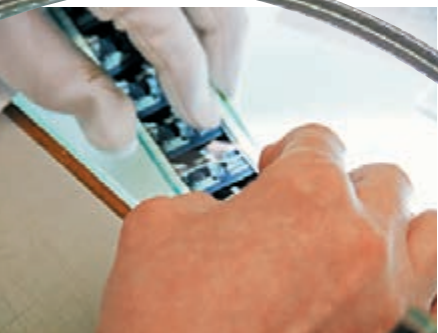
■用特殊膠紙修補斷裂的菲林齒孔。
