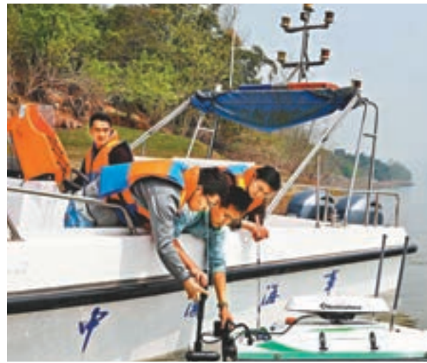
長江入河排污口排查整治專項行動在重慶試點。圖為利用無人船聲納裝備對長江水下排污口進行探測。
