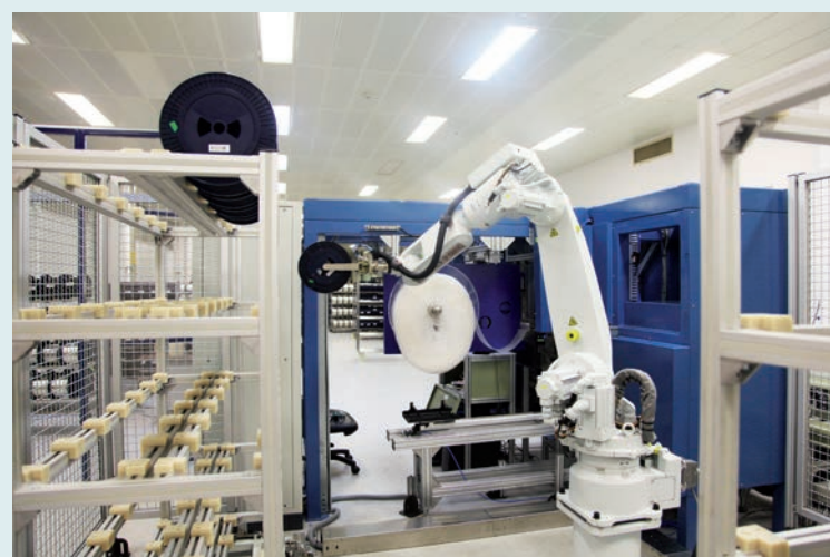
長飛光纖自動包裝流水線上的機器人。
