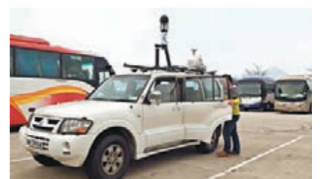
地政總署同事會透過航空測量、無人駕駛飛行系統、車載移動測繪系統等收集具質素的地理資訊。
