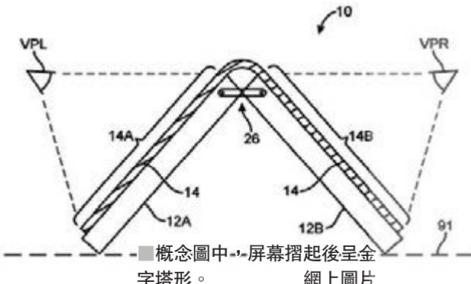
概念圖中，屏幕摺起後呈金字塔形。
