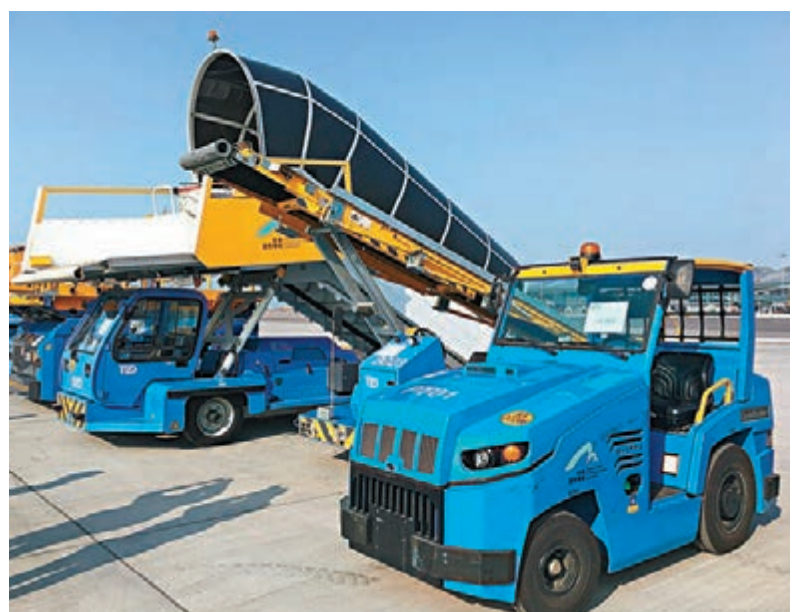
■機管局已添置200部地勤設備。圖為大馬力拖車(右)及電動機場客運升降台(左)。
