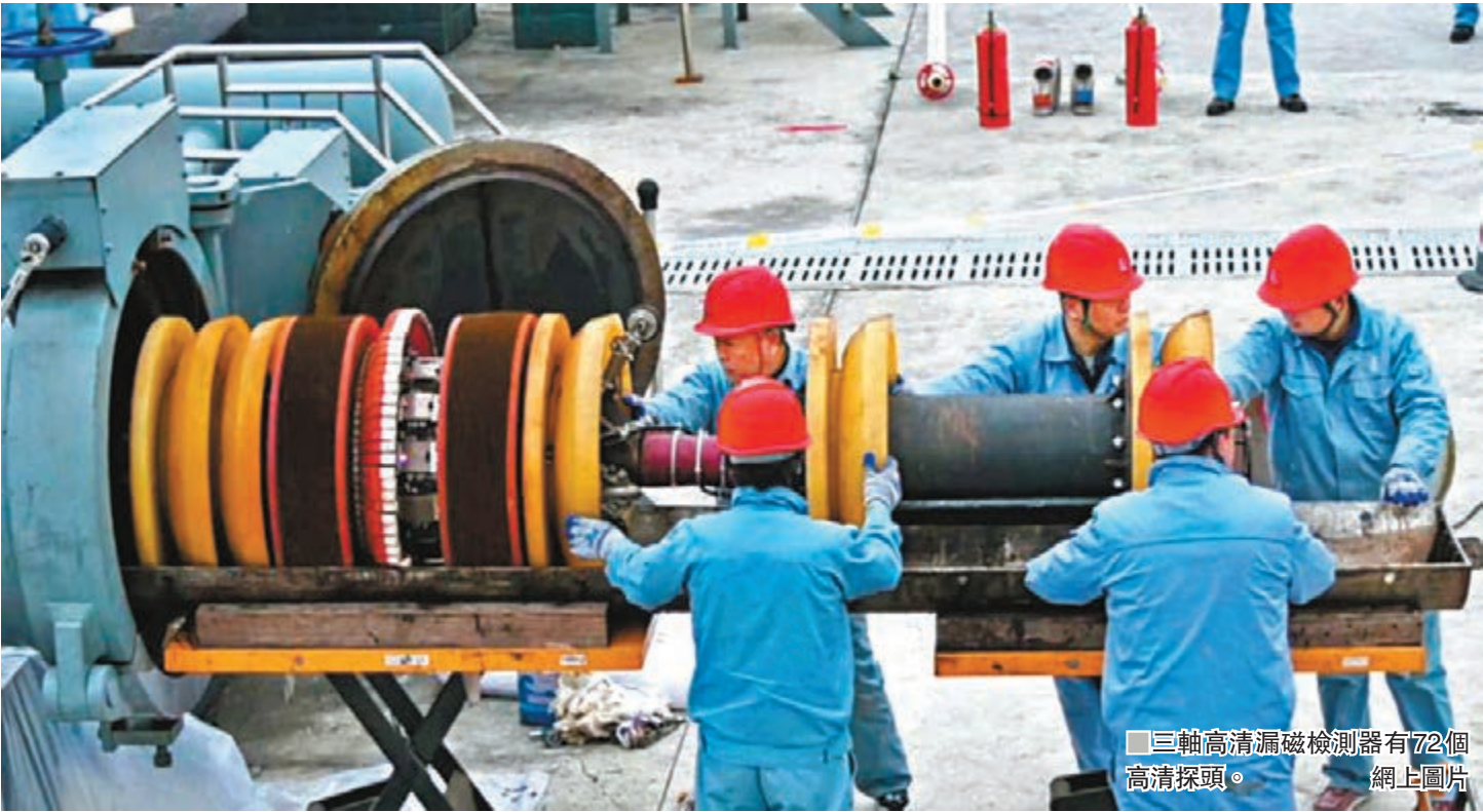
■三軸高清漏磁檢測器從白沙灣站收球筒中緩緩移出，標註着杭州灣海底管道內檢測成功。網上圖片
