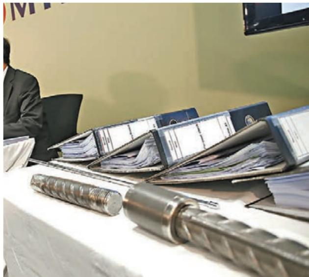
路政署昨晚公佈最新檢測結果，在14支鋼筋中，再有4支鋼筋的螺絲帽不達標，其中一支鋼筋只扭入螺絲帽9.4毫米。圖為港鐵早前召開記者會交代事件時展示的鋼筋及螺絲帽。
