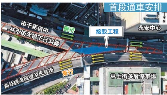
繞道隧道通車，林士街天橋東行連接干諾道中的下行斜路的所有行車線將封閉（紅線示），並進行接駁林士街天橋的工程，需時約一個月。
