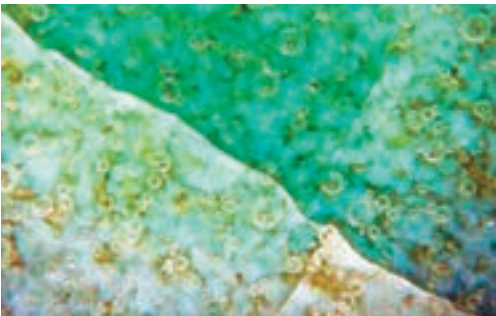
顯微鏡下，汝瓷釉面生成的小氣泡猶如「星辰」，絮狀物宛若「雲彩」。網上圖片
