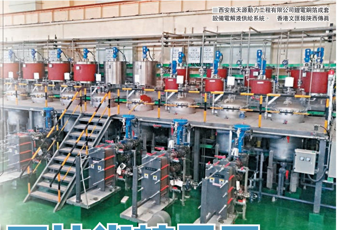
西安航天源動力工程有限公司鋰電銅箔成套設備電解液供給系統。香港文匯報陝西傳真
