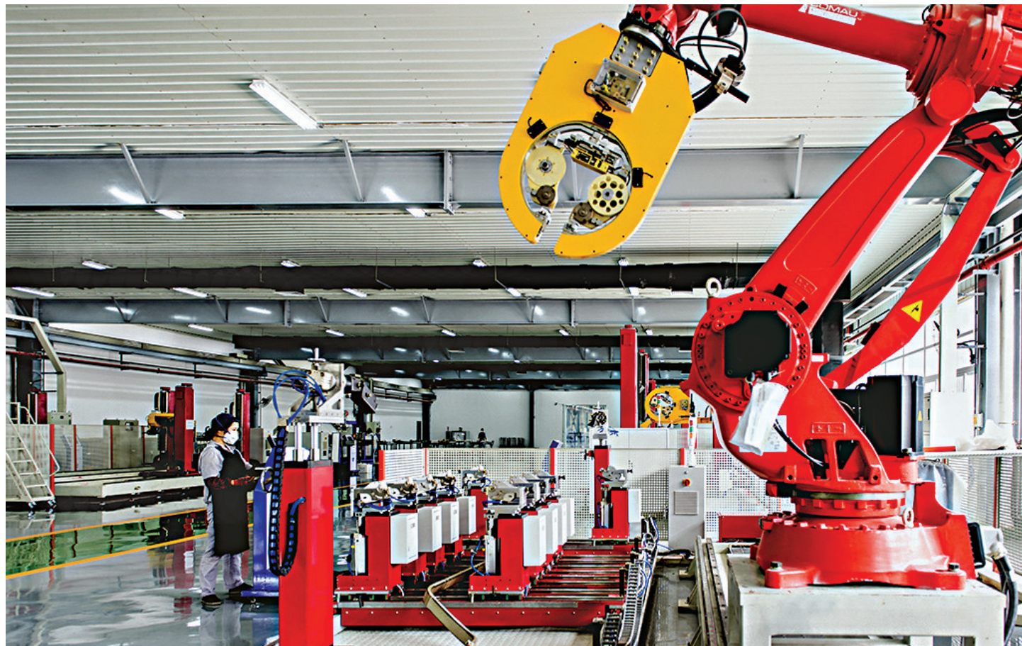
重慶機電下屬企業重慶水輪機廠的機器人包帶機設備
