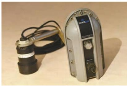
超聲波傳感器(左)實時量度雨水井和污水井水位,然後將資料經由數據收集器(右)傳送至電腦分析。
