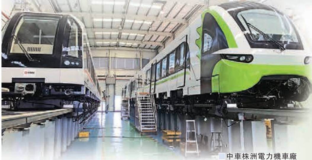
中車株洲電力機車廠自主研製的商用磁懸浮2.0版列車，設計時速提高到160公里 譚錦屏攝
