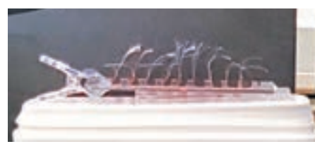
■「氫氧化鋁」在光作用下體積收縮,向前彎曲。 香港文匯報記者柴婧 攝
