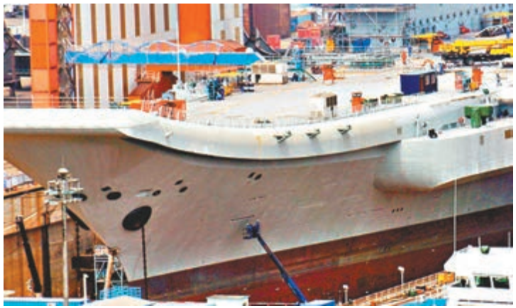
上周日，國產航母完成首次海試後正在塢內進一步舾裝，圖為工人對國產航母首部位的塗裝進行清理。香港文匯報記者 宋偉 攝
