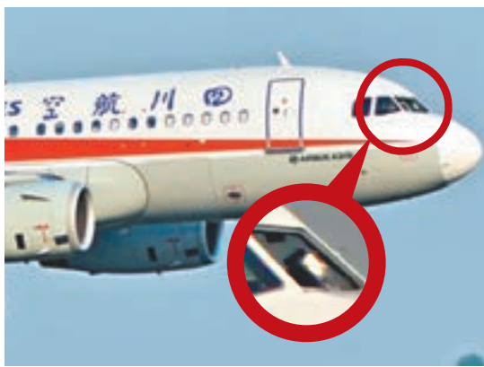
飛行過程中，駕駛艙右座前風擋玻璃破裂脫落。新華社 在失壓的駕駛艙中，多個設備損毀失靈。中央社
