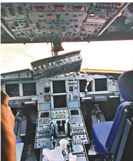
飛行過程中，駕駛艙右座前風擋玻璃破裂脫落。新華社 在失壓的駕駛艙中，多個設備損毀失靈。中央社
