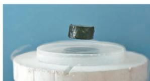
受冷凍的超導體能夠長期維持電流流動，產生磁場，因此能令磁鐵長期漂浮於空中。網上圖片
