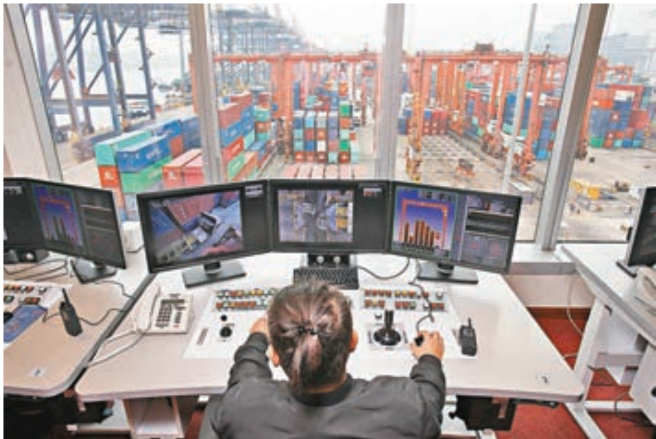
■全港首個貨櫃碼頭吊機遙距操作及貨箱自動堆疊系統啓用。香港文匯報記者劉國權 攝
