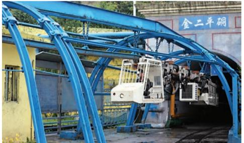
■去年8月，礦井輔助運輸系統推廣使用單軌吊在盤江集團屬下金佳礦取得成功，現已在集團屬下煤礦逐一推開。
