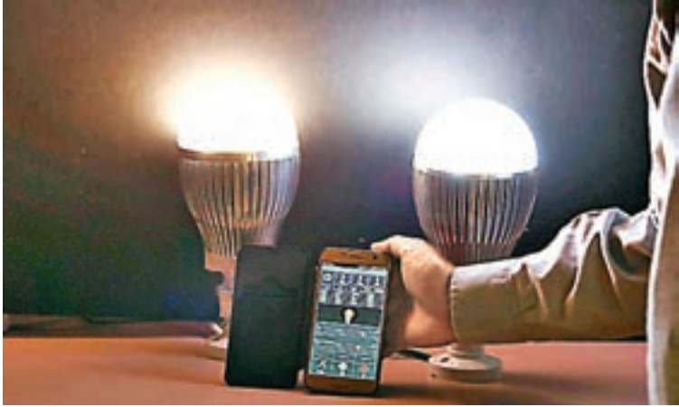
■許樹源及其團隊最新的發明，一個可準確調節LED照明光暗度和色溫的智能系統，能準確調校黃白光的轉換和光暗度。
