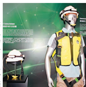
能即時感應建築工人身體狀況的物聯網安全帽。香港文匯報記者 聶曉輝 攝
