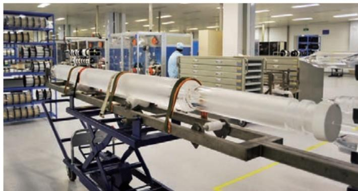
■長飛生產的預製棒產品,直徑達到210mm,屬全球最大。
