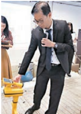
■賴緯樂示範使用管線儀檢測地下金屬設施。香港文匯報記者黎恣攝
