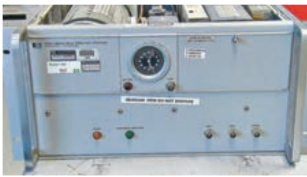
Hafele及Keating用來進行實驗的原子鐘。網上圖片
