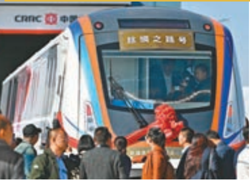
昨日，新疆首列本地製造的地鐵列車「絲綢之路號」在烏魯木齊中車產業園軌道交通裝備基地正式下線，這標誌著新疆軌道交通裝備產業實現零的突破。據介紹，此次下線的列車為A型車，採用6節編組，列車總長140米，高度3.8米，車廂淨高2.1米，整車最多可載客逾2,600人，最大運行速度為每小時80公里。文/圖：中新社
