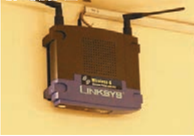
路由器的較佳安裝方式，是貼在牆上較高位置。
