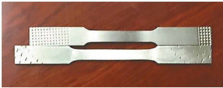
「超級鋼」拉伸前後比較。上為拉伸前，下為拉伸後。
