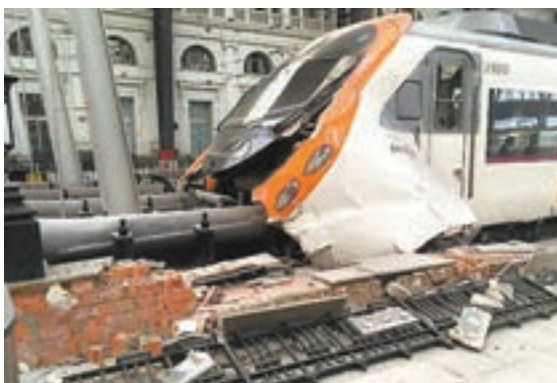
■列車撞向月台末端的緩衝金屬物，車頭損毀嚴重，大片金屬被扯脫。法新社
